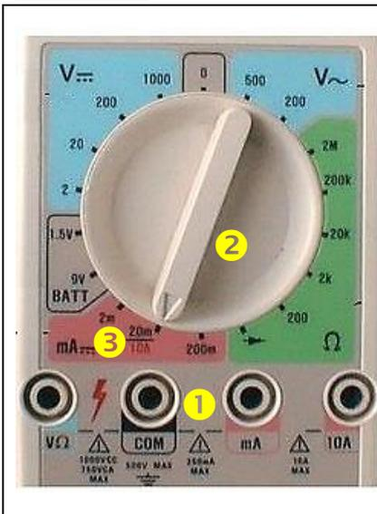
Un multimètre (« multi » : plusieurs ; « mètre » : mesurer) est un appareil permettant de mesurer la valeur de différentes grandeurs électriques : intensité du courant, tension ou résistance.
