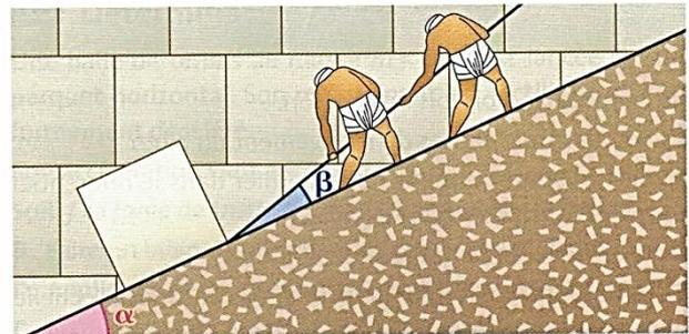
Un bloc de pierre de masse  $m = 2,0 \cdot 10^3 \text{ kg}$  est tiré par plusieurs hommes à l'aide d'un câble faisant un angle  $\beta = 10^\circ$  avec la rampe inclinée elle-même d'un angle  $\alpha = 20^\circ$  par rapport à l'horizontale.
