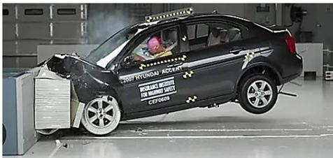
Les crash-tests permettent d'améliorer les systèmes de protection équipant les véhicules, comme les ceintures de sécurité, les airbags, les pare-chocs, etc. Lors de ces tests, un véhicule est lancé à différentes vitesses contre un obstacle (un mur par exemple). Au moment de l'impact, le véhicule s'arrête brutalement : sa vitesse, et donc son énergie cinétique, s'annulent quasi-instantanément. Le véhicule subit alors d'importantes déformations mesurées avec précision.
